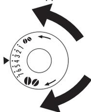
*Для обеспечения более медленной подачи кофе и улучшения вида пенки поверните ручку против часовой стрелки (более мелкий помол).*
